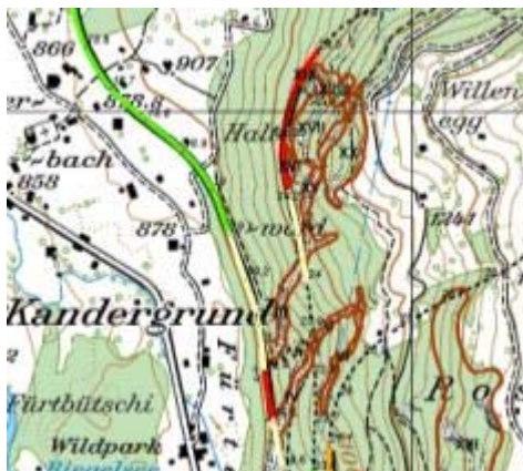
Figure 13 : Le risque collectif affectant la voie ferrée est échelonné quantitativement entre le niveau faible (ligne vert clair) et très élevé (ligne rouge). Le pourtour des zones d'apport déterminantes est dessiné en brun.
