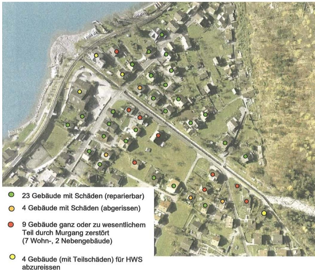
Abbildung 18: Übersicht zerstörte und beschädigte Häuser auf dem Kegel des Glyssibach (Quelle: Lokale lösungsorientierte Ereignisanalyse Glyssibach, 2006).
