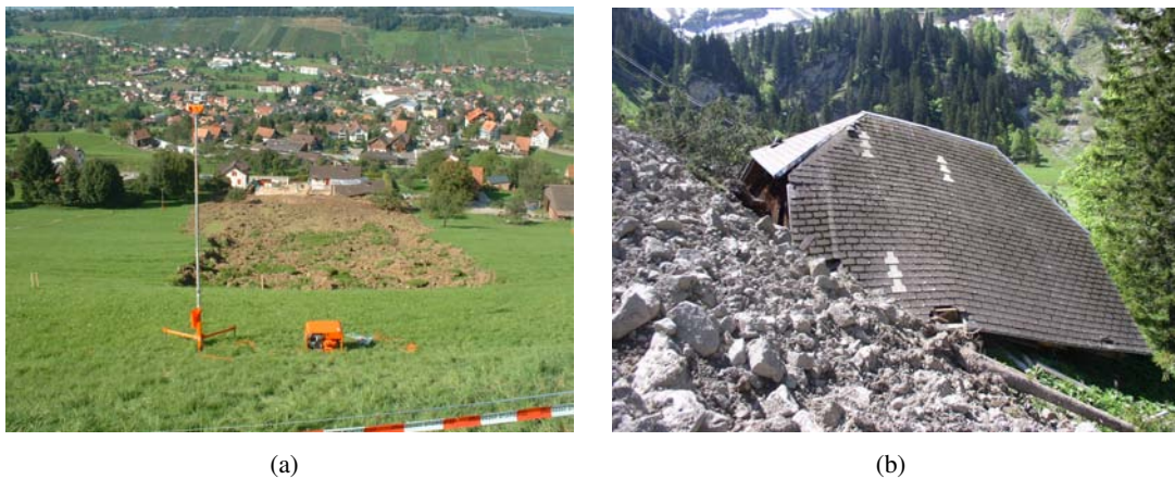
Abbildung 1.4: Die spontane Rutschungen, die durch den hohen Wasseranteil in Hangmuren übergegangen sind, zerstörten die Gebäude durch den Staudruck. Foto: GEOTEST AG (a,b).
